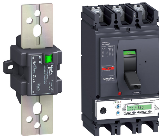
Рис. 2.7. Пример ComPact NSX630 со встроенным расцепителем MicroLogic 6.3E с защитой от замыкания на землю и измерениями и внешним трансформатором тока защиты нейтрали
