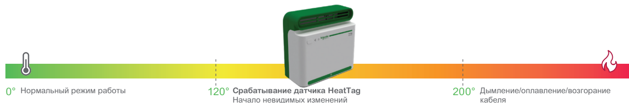
Рис. 1.9. Диапазон температур, в котором работает датчик HeatTag
